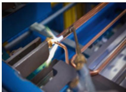
Verbindung von Mäander und Headerrohr durch Löten.
