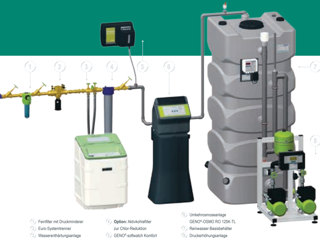
Standard-Anlagenschaltung GENO®-OSMO mit Wasserenthärtung als Vorbehandlung und Aktivkohlefilter zur Chlor-Reduktion
