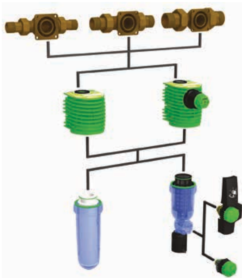
Modularer Aufbau der Filterbaureihe BOXER®
